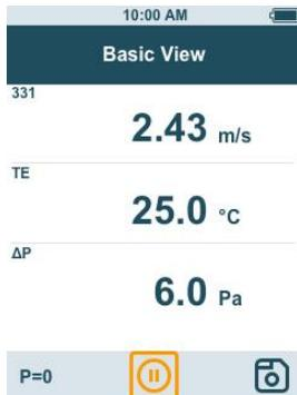
В зависимости от подсоединенного зонда можно настраивать параметры для измерения, например, отображение отдельных значений или единиц измерения.
