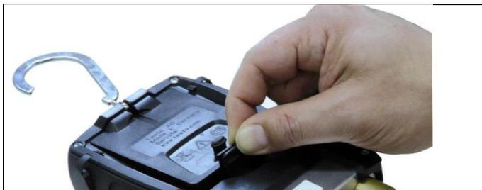
1. Раскройте подвесной кронштейн, ослабьте фиксатор и снимите крышку аккумуляторного отсека.
