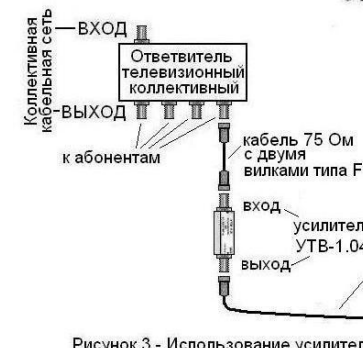
Рисунок 3 - Использование усилителя в коллективных кабельных сетях
