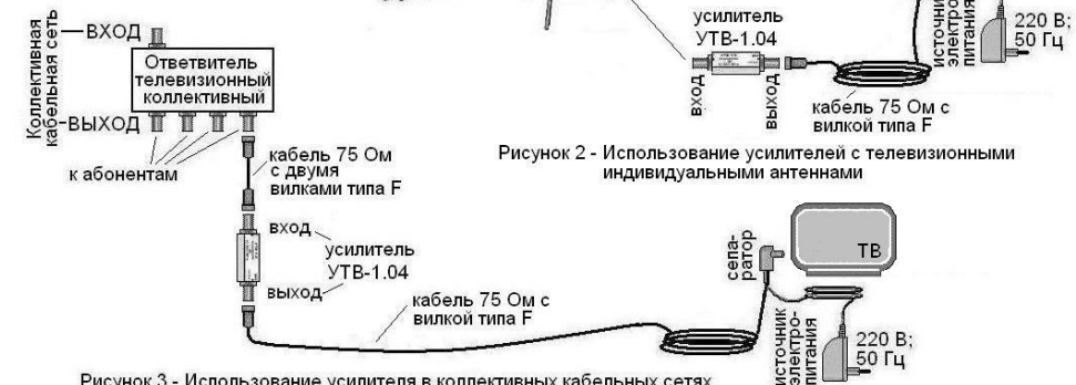
Рисунок 3 - Использование усилителя в коллективных кабельных сетях
