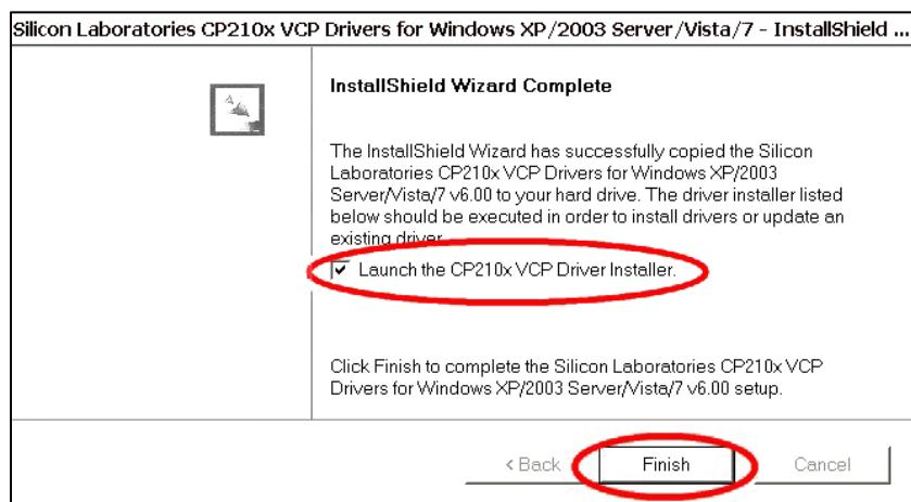
Первый этап установки – разархивирование пакета драйверов и запись их на жесткий диск Вашего компьютера. Установщик запишет пакет драйверов по адресу C:\SiLabs\MCU\CP210x\Windows\_XP\_S2K3\_Vista\_7\ и предложит начать второй этап – собственно установку
