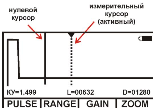
При нажатии кнопки [MODE] прибор покажет кабель полностью. Этот режим называется «КАРТА». Повторное нажатие приведет к восстановлению установленной растяжки вокруг активного курсора. Вы можете то просмотреть кабель целиком, то только область растяжки. В режиме «КАРТА» прибор выводит карту кабеля, и экран принимает вид, показанный на рисунке.
