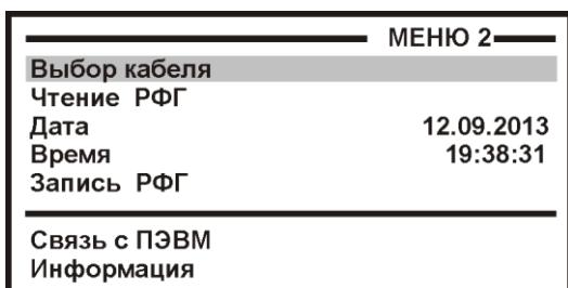
Если кабель не занесен в Список, то в пункте <Выбор кабеля> следует выбрать пустую запись. Например «02-я запись». Выбранная запись помещается в «карман». Для ввода параметров нажмите кнопку [НАСТРОЙКА].
