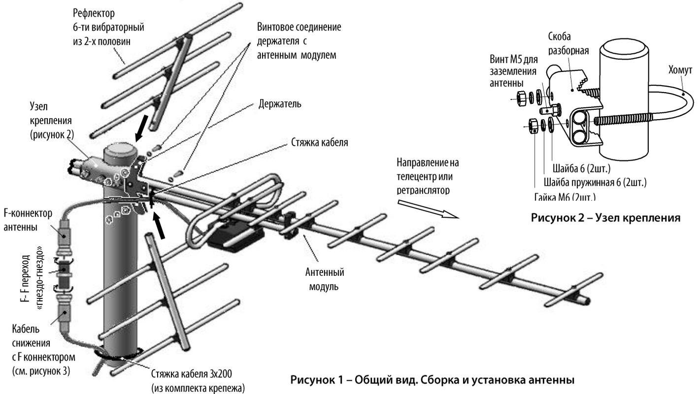
Рисунок 1 – Общий вид. Сборка и установка антенны
