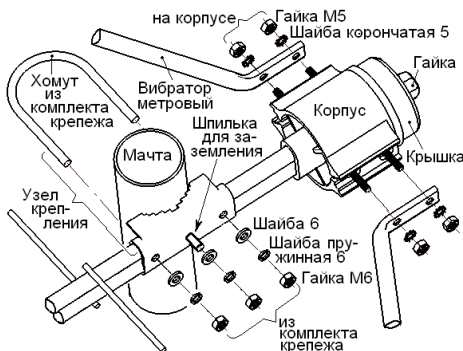
Рисунок 3 - Сборка антенны
