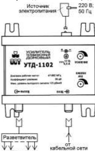
Рисунок 1 - Общий вид и подключение усилителя к внешним устройствам
