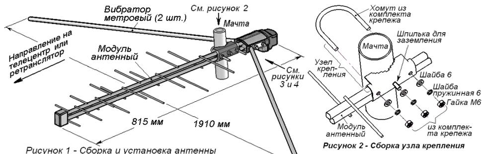
Рисунок 1 - Сборка и установка антенны
