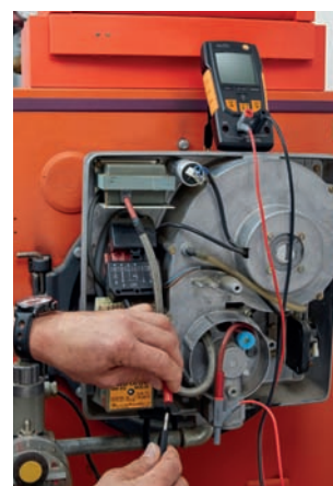
Подготовка к измерению ионизационного тока
