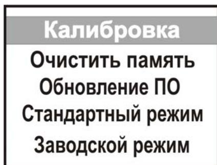
**Калибровка** – режим калибровки входных каналов А и В (проводится при первичной настройке прибора на заводе-изготовителе)
