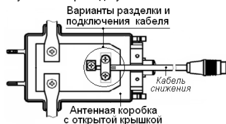
Рисунок 3 - Разделка и подключение кабеля снижения
