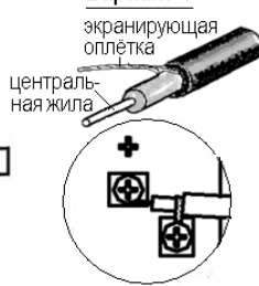
Рисунок 3 - Разделка и подключение кабеля снижения
