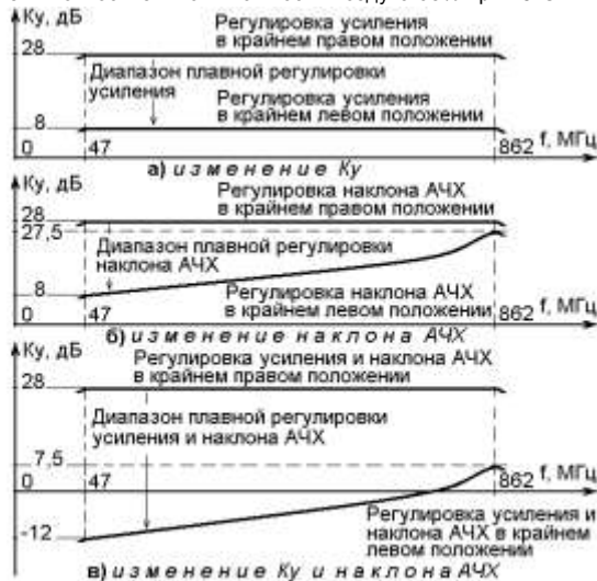
Рисунок 2 - Изменение амплитудно-частотной характеристики (АЧХ) усилителя с помощью органов плавной регулировки
