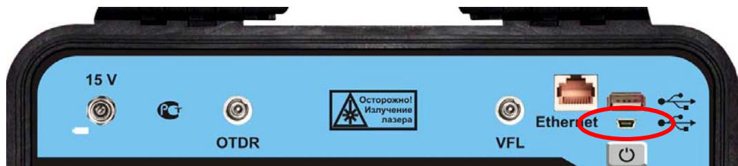
Рис. 98. Разъем mini USB для подключение прибора к ПК.
