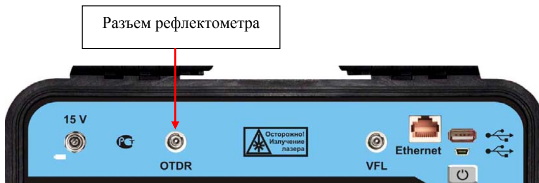
Рис. 12. Подключение оптического волокна.
