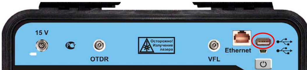
Рис. 50. Подключение Flash накопителя.
